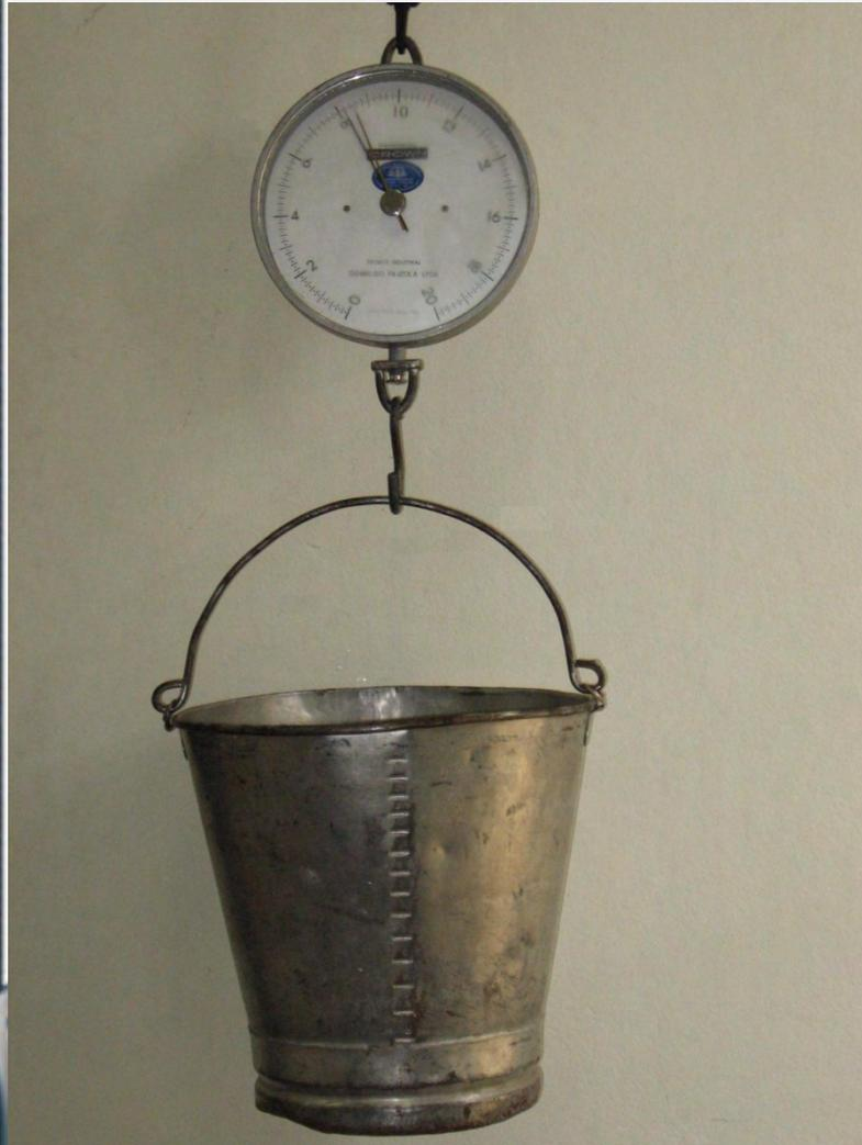
Dinamômetro (balanza tipo reloj)
